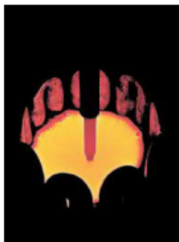
銅管の中で溶解するニオブ酸リチウム
