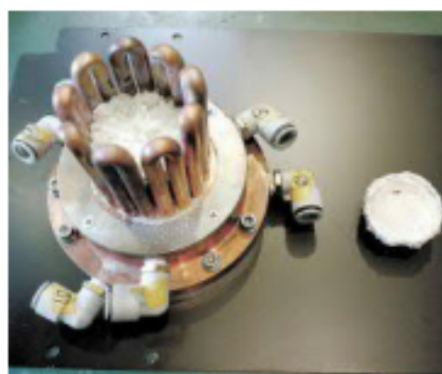
実験に使われた銅管の容器（左）と溶解したニオブ酸リチウム
